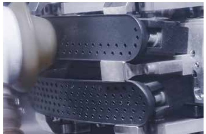
Foto de Proceso de Perforación
